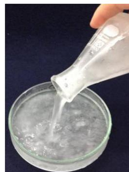
吸収式冷凍機の原理で氷スラリーを作ることで、廃熱のエネルギーを冷凍・冷房用途で有効利用する研究。左図は自作の実験装置。装置内で水を減圧して蒸発させ、蒸発潜熱による冷却作用で右図のような氷スラリーを生成します。吸収式冷凍機の再生器に廃熱を供給し続けることで連続的に氷を作ることができ、周囲を冷やすことができます。
