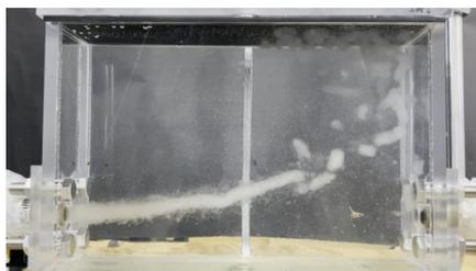
0°Cの冷熱輸送に適した熱媒体の氷スラリーの輸送・回収実験の様子。新しい技術なので、実験に使う装置は学生の手作りのものばかりです。
