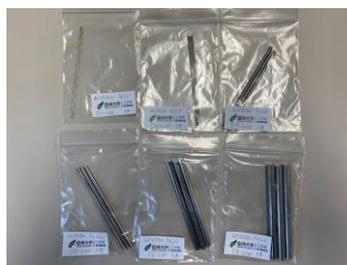
直径1mm以上の大径磁気双安定素子開発加工による残留応力と磁気特性を評価
