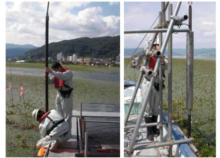
閉鎖性水域（諏訪湖）における底泥のサンプリングと湖底地盤の強度調査および密度検層
