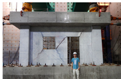
大地震時の損傷を抑制する技術開発に関する構造実験例（高いひび割れ抵抗性を有する繊維補強コンクリートを壁に利用することで、損傷低減効果と高い剛性・強度を兼ね備えた建物が実現可能）。
