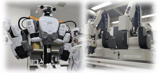
双腕型ロボットやロボットアームを活用した自動実験環境の構築を進めています。これにより、既存の100倍以上の実験速度向上を目指します。
