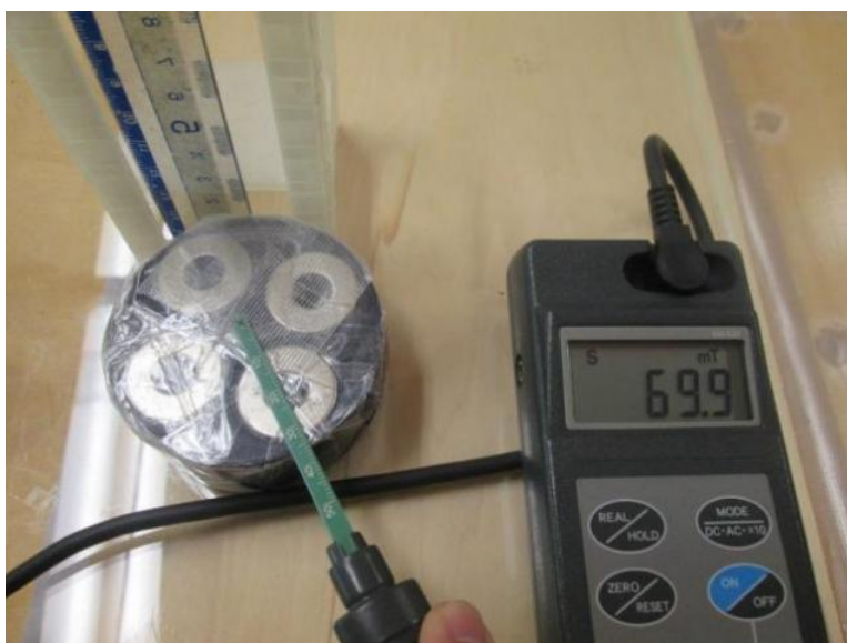
試作したカプセル内視鏡用磁気誘導磁石の一例[2]
