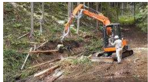
ハーベスタを操作して枝払い、玉切、集積の一連の作業を実施
