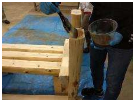
図11. 塗装 心材と辺材との浸透速度の 違いを確認
