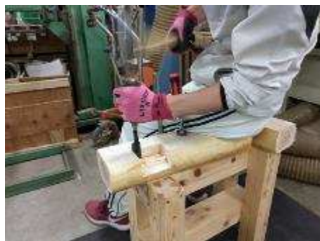
図 7.のみ加工 木材の繊維方向に注意して掘る
