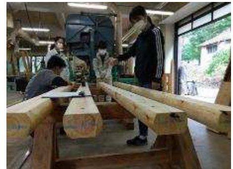
図 4.木取り作業 素材の中心に墨付け
