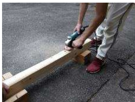
図9. 節を削る表面加工 回転工具なので素手で行う
