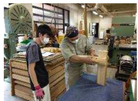
図 8. うまく組み合わさるか確認 必要に応じて微調整を行う
