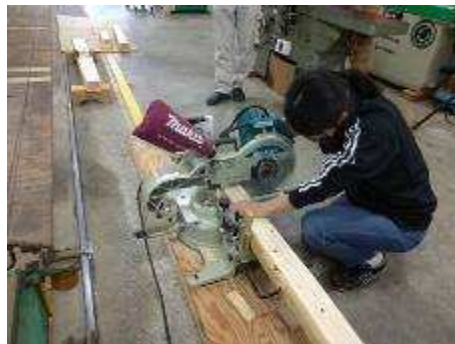
図 5. 指定の長さに丸鋸で鋸断 長さ方向に対する鉛直が肝要
