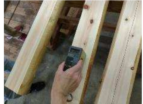
図 3.含水率 2日目以降も計測して 素材が乾燥する様子を確認
