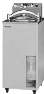
図5 オートクレーブ（加圧滅菌器）
