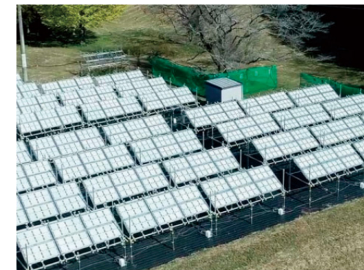
堂免・久富チームが開発した100 m規模の試作「水分解パネル」の空中写真
