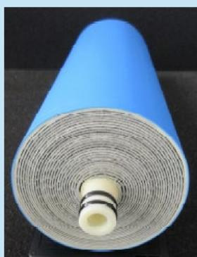
直径4インチモジュールを試作し、海水から淡水を造るパイロット試験等に適用しました。
