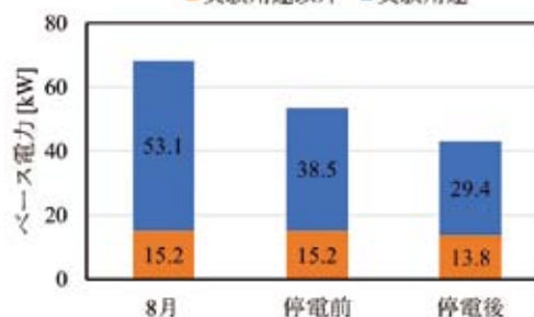
図2 実験施設Aの8月・停電前・停電後のベース電力
