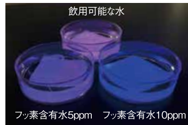
フッ素濃度モニターに水中のフッ素が吸着して変色。濃度によって色が異なる。
