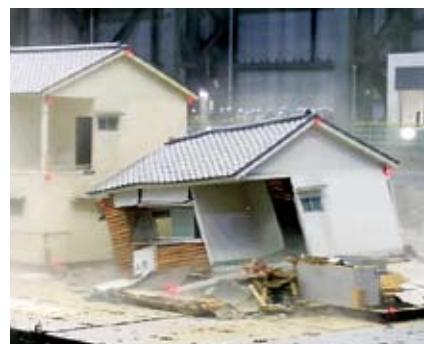
安全な木造住宅の開発(補強と無補強建物の実験)
