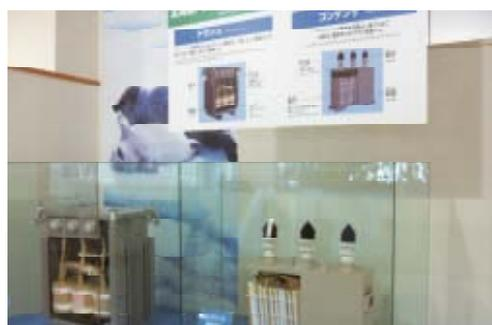
PCB 含有コンデンサーの模型
