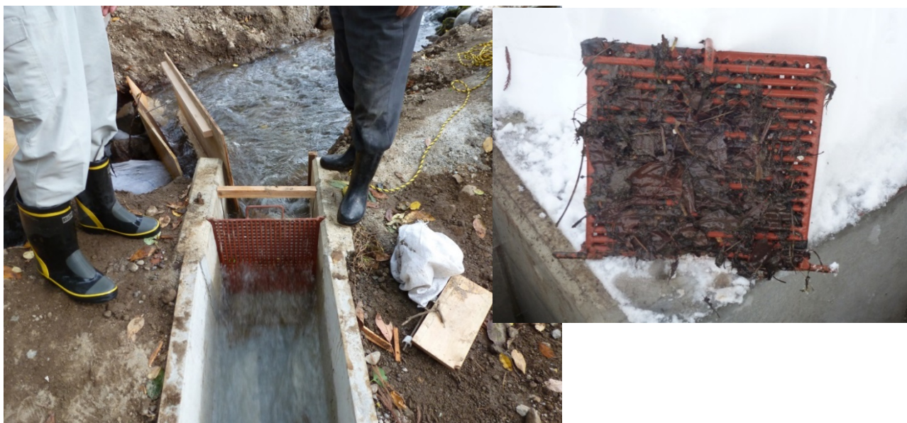
写真 2-3 従来スクリーンの目詰まり状況
