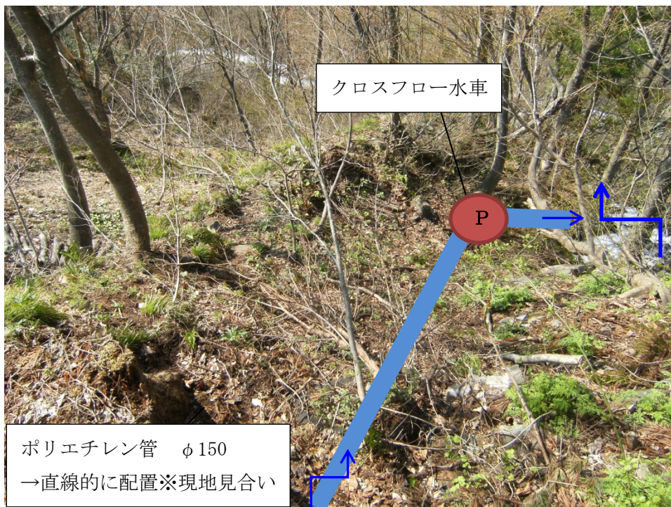
図 2-13 配管ルート図（崖上から撮影）
