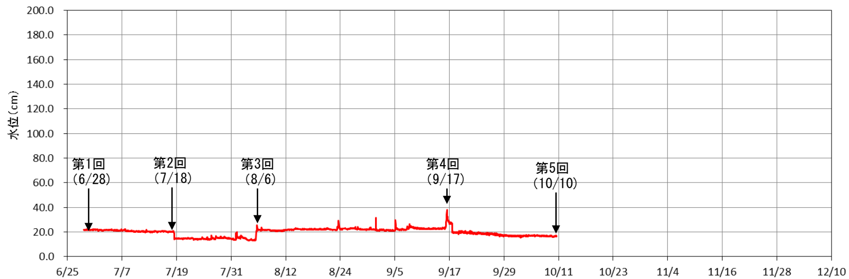
図 2-1 圧力水位計による時系列水深グラフ (6/28~10/10 : 水路水位計測定)
