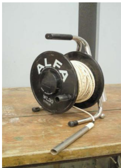
写真- 3.2.2 地下水位観測に用いたセンサー (左：ロープ式水位計，右：DL/N70型ロガー付水位計)
