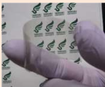
無機系カーボンナノチューブ分散剤を用いて作製した透明電極膜
