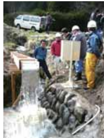
湧水で発電する湧水車。この電気で電気柵を設置したところ鳥獣被害が減り、年間で導入費用の半分以上の農業収益が上がったという
