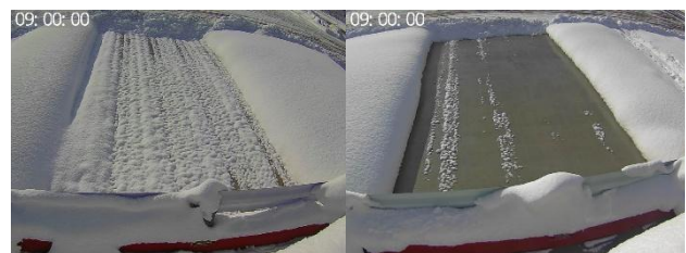
(a)通常コンクリート (b)人造黒鉛コンクリート 写真-2 積雪・融雪状況の一例 (2025/2/20 9:00)
