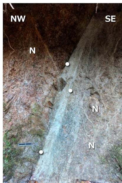
図16 稲葉断層の断層ガウジを伴う剪断面
