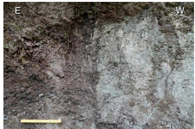
図 13 Loc. 5 断層角礫・断層ガウジ
