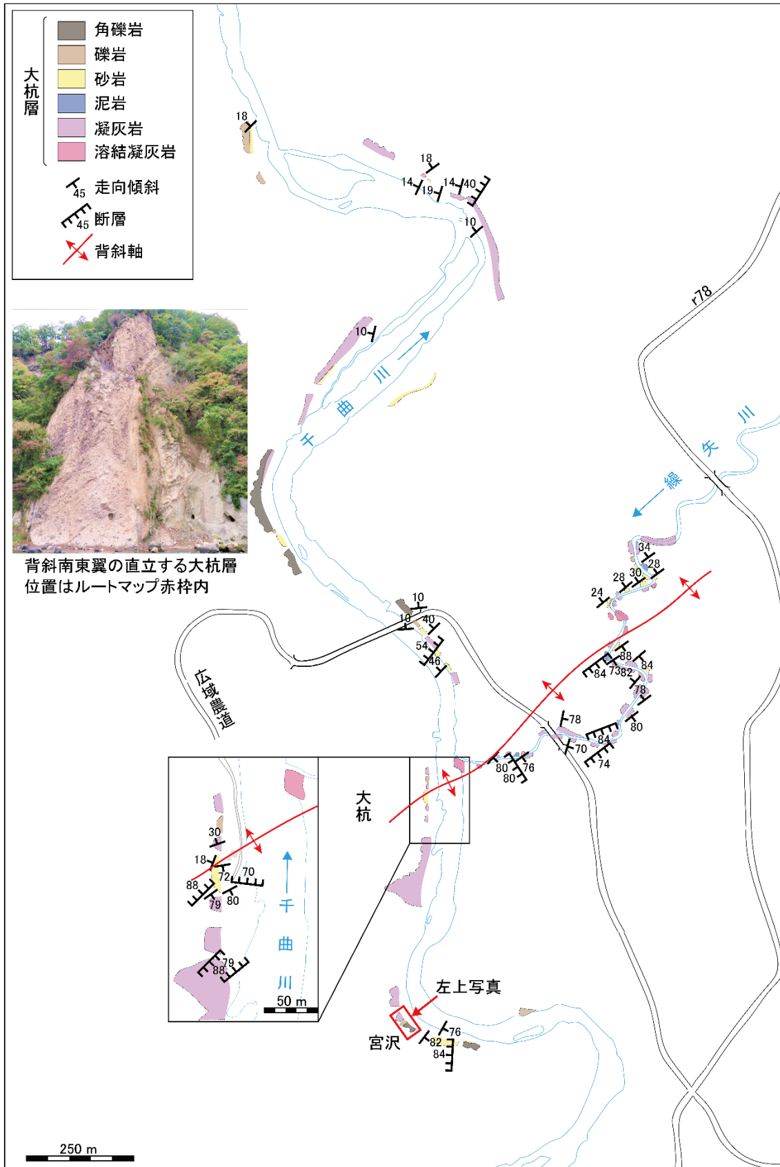
図-40 大杭背斜および断層群 F3 を示すルートマップ(図-8 の Loc.28・29) 小諸市大杭地区周辺では、下部更新統が参加する背斜とそれを切る断層群 F3 が存在する。
