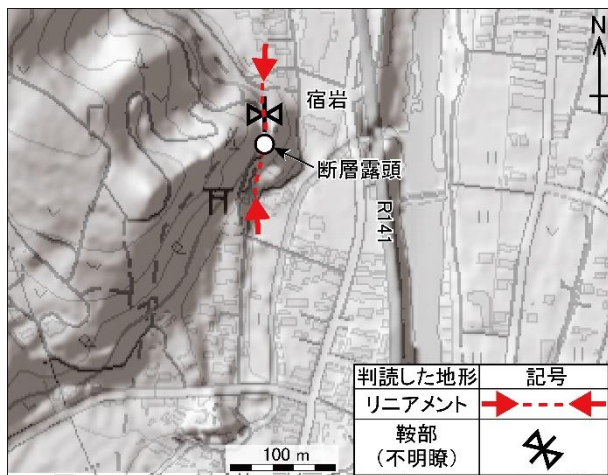
図-37 断層 F1 のリニアメント 断層鞍部地形上に断層露頭が認められる。 国土地理院の陰影図を使用。
