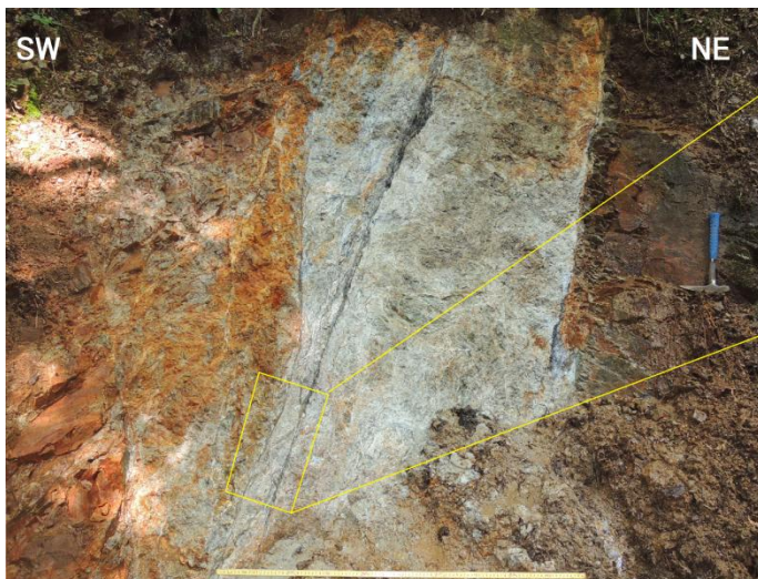
図-18 内村層の火山岩に変位を与える北西-南東走向の断層(Loc.7) 断層ガウジの複合面構造は南西側下降運動を示唆する．栃ノ木沢左岸標高 1000m 付近．
