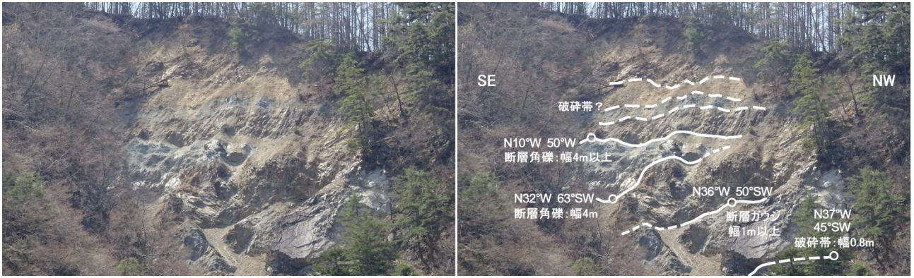
図-19 崩壊地に露出する北西-南東走向・南-北走向の断層(Loc.8) 薄川第四発電所付近の薄川左岸斜面。
