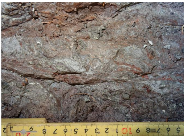
図-24 北東-南西走向の左横ずれ断層(Loc.13)
