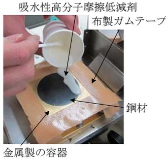
(a) 吸水性高分子基材の鋼材への塗布状況 (その1)
