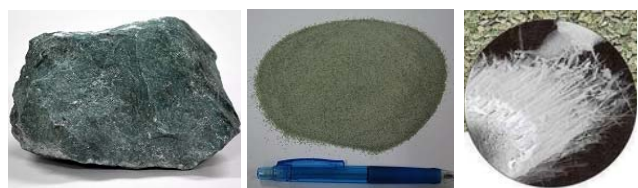
(a)モルデナイトを主成分とする天然ゼオライト (b)粒度調整後(粒径0.5mm以下) (c)電子顕微鏡写真 6),7)
