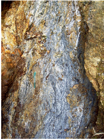
図9 北露頭 断層 17 の粘土を伴うガウジ
