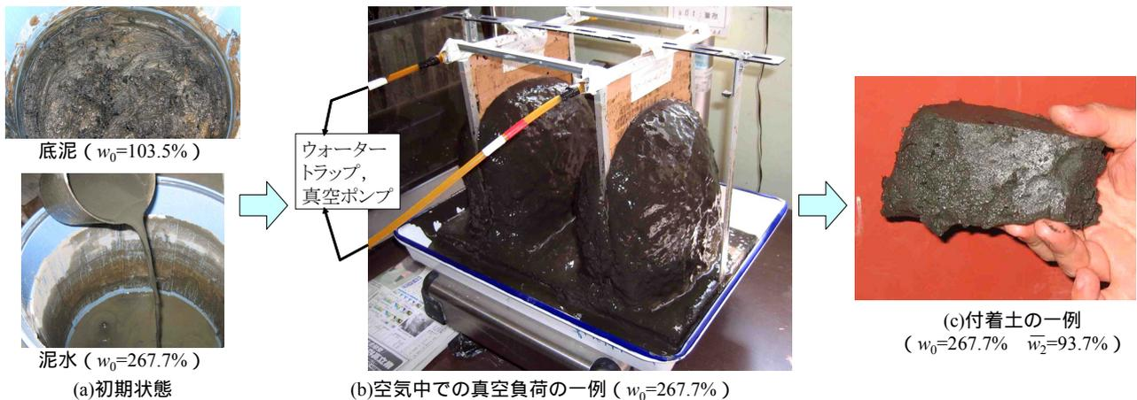
図-8 小型脱水実験の脱水状況 (諏訪湖の底泥および泥水)
