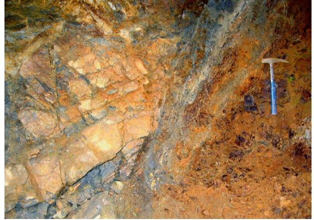
図-7 砂岩・泥岩を切る断層(F5) 写真の右側はガウジと断層角礫。
