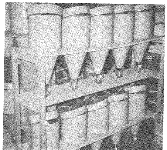
写真2：内川ら(1985)に従って作製したアダプター（スチール製の篩とビニール管ループ）(上)と作動中のツルグレン装置(下)
