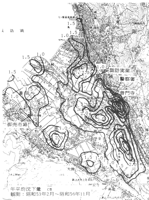
図3. 諏訪盆地の地盤沈下状況 （長野県諏訪建設事務所資料）
