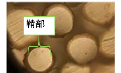
燃えやすいセルロース繊維の鞘部に気体ブロック性の高い無機フィラーを導入した芯鞘構造を有する難燃性の再生セルロース繊維を作製(繊維断面図)
