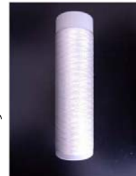
再生セルロース連続繊維を1kgオーダーで作製
