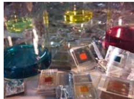
さまざまな色素の溶液とその色素から作製した色素増感太陽電池。デザインの良い太陽電池の作製も可能
