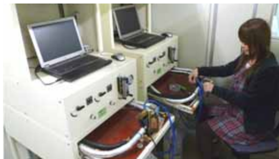
研究室で開発した材料を組み込んだ燃料電池は、その発電特性を評価装置でチェック。その結果を基に、さらなる改良を重ねます
