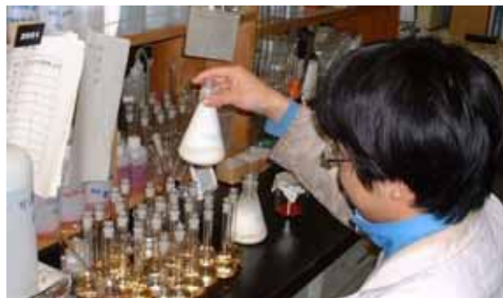
合成した助剤を手を持って観察し、染料、高分子、助剤の結合を調べるためにそれらを含む水溶液の調製する
