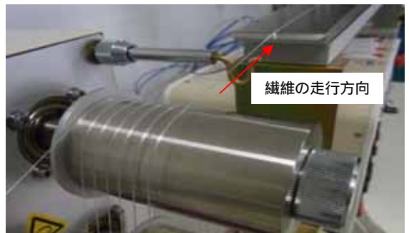
作製した繊維を加熱プレート上で延伸（引き延ばし）を行っているところ。この処理により、繊維強度は10倍以上大きくなる
