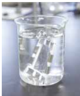
酢酸セルロースをアンモニアで煮て、高分子の変化を探る
