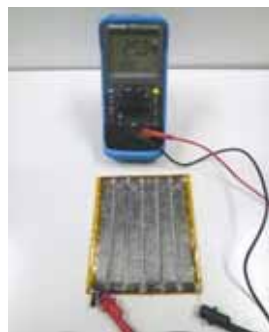
6セルを直列に一体成形した厚さ約4mmのフレキシブル燃料電池
