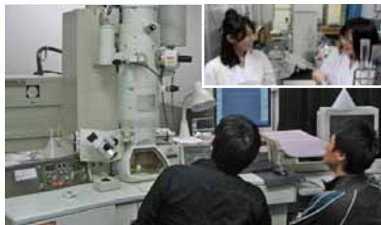
様々なナノ物質を化学合成し（右上挿入図）、透過型電子顕微鏡（TEM）などを駆使してナノ物質の形態やサイズを確認する（下図）
