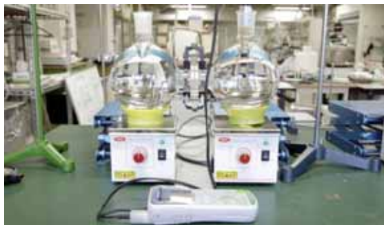
左が塩水、右が真水で、間にあるフィルムを通して塩分がどれだけ真水側に移動するのかわ、塩分濃度計で測定する
