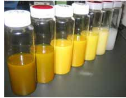
見た目は一見牛乳のようですが...高分子微粒子は、通常水中に分散しています
