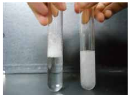
アルカリ加水分解性の界面活性剤（洗剤）溶液に弱アルカリを少量加えると直ぐに泡が消えて固体（分解物）が析出する
