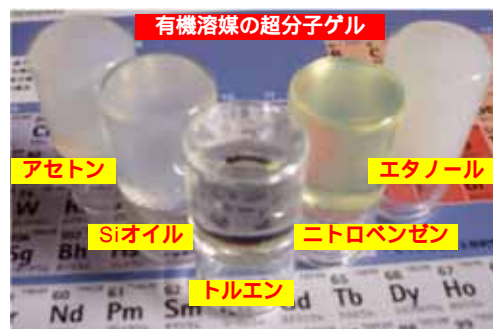
L-アミノ酸系低分子ゲル化剤によって形成された有機溶媒の超分子ゲル。逆さまにしても落ちてこないほどしっかりとゲル化している
