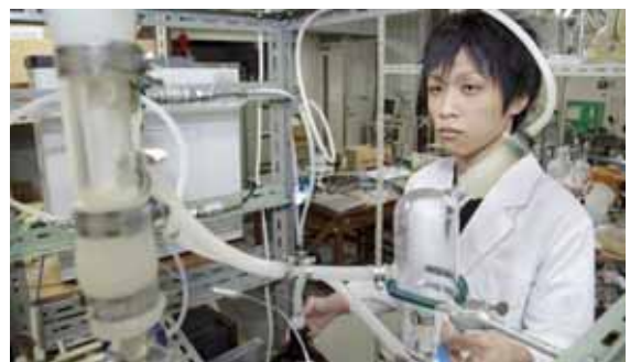
中空糸膜によるCO 2 の吸収度合を比較検討するため、その過程を分析する。この吸収・放散装置は学生自身が設計し、実験を行っている
