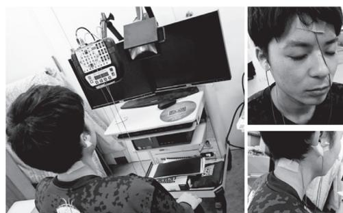
図 4 脳波計及び電極装着状況
