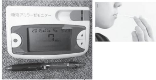
図5 唾液アミラーゼモニター及び測定状況
