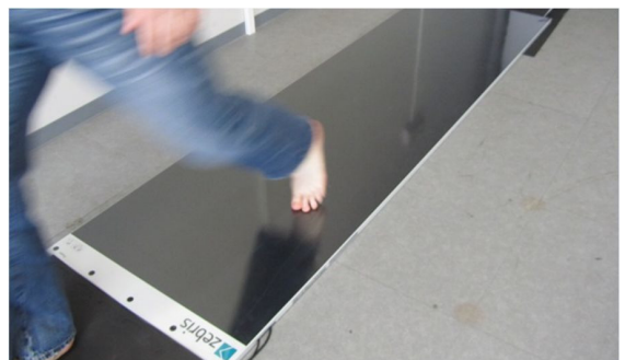
圧力板という圧力測定センサー配列システムを5mmと200Hzの解像度で測定し、ヒトや動物の力学的歩行動作を細かく検査する
