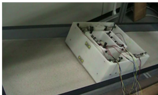
これは、砂中に沈下せずに移動できるロボット。接している面を平面にし、ピンを地中深くに挿入し自重を支持させている
