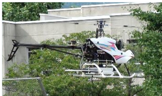
鈴木研究室で開発した空中ロボットの1つである自律小型無人ヘリコプタ。自律制御技術によって人の操縦なしで飛行可能
