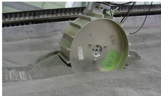
月惑星探査ロボット用の車輪は、金属系の材料で作られています。そのような車輪が軟弱地盤で走行すると、砂中に埋まってしまいます
