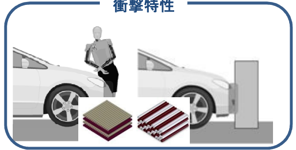
スーパー繊維とカーボン繊維のハイブリッドによる、緩衝特性と衝撃強度が共に優れたFRP構造の開発
