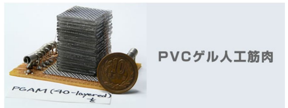
PVCゲル人工筋肉 高分子ゲルや細胞培養技術を用いた人工筋肉の創製
