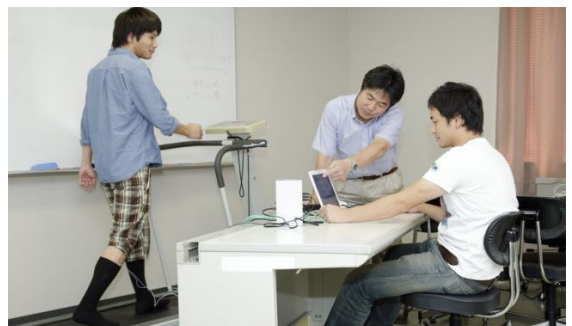
トレッドミルを使いソックスの衣服圧の変動を測定。足に圧力センサーを付け圧の変化で履き心地を数値化し、データを解析する
