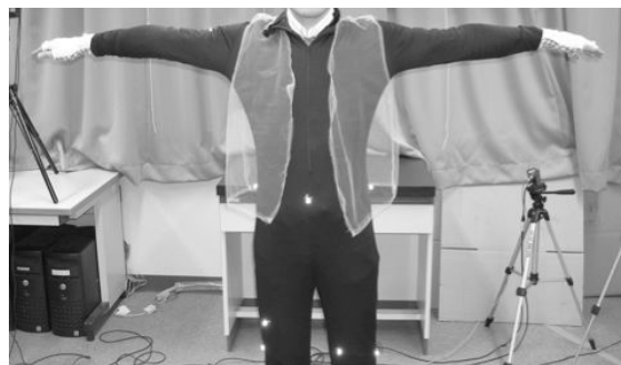
モーションキャプチャ（人間の動作を計測して記録する）の装置を用いて、人間が衣服を着装する動作の計測を行っている
