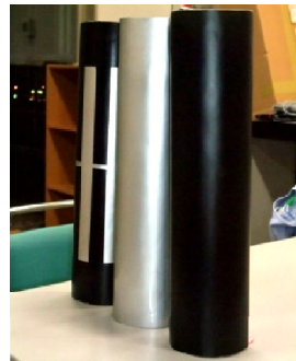
気流、気温、熱放射、それぞれ効果を測定する装置の開発
