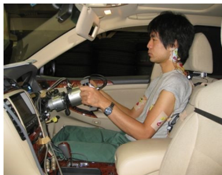
自動車の運転のしやすさを筋や心臓などの生理活動を計測することによって評価する研究
