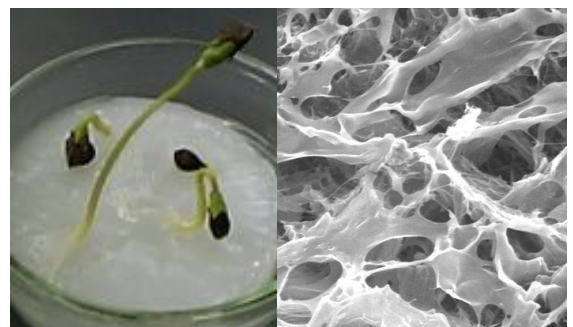
乾燥地用緑化のために種子が発芽し成長するような水溶性高分子ゲルシートを作製し、その微細構造を電子顕微鏡を用いて解析する
