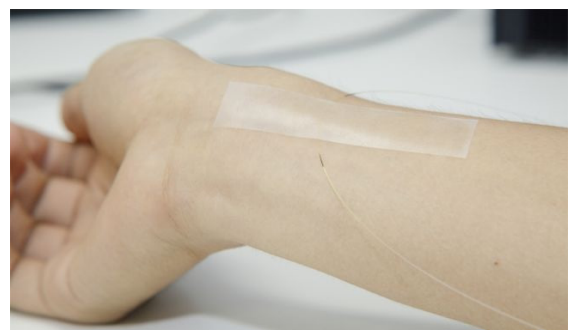
肌に触れていることさえ忘れてしまうほど極細の光ファイバーでバイタルサインを計る。採血のように痛みを伴うことなど全くない
