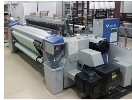
高速・高性能な繊維機械の一つ「エアジェット織機」 産業革命以来連続と続く技術開発の偉大な成果
