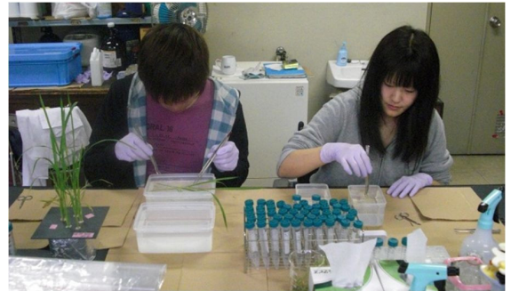
高濃度のNaClを含む（塩ストレス）水耕液を処理したイネに、Na + を中心とするイオンがどのように蓄積するか、その蓄積量を測定するための作業の一風景です
