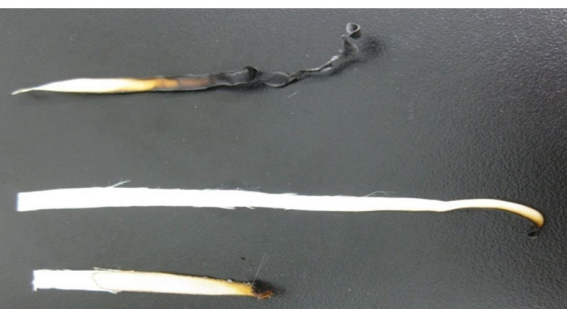
炎を近づけても燃えにくいシルクができました。試料下端を着火し、炭化状態を観察した写真 未処理（下）、化学加工した防災性シルク（中、上）
