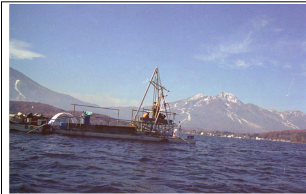
野尻湖における湖底掘削の風景。湖面から湖底まで鉄パイプをおろして、湖底の堆積物を45mの深さまで採取した。背景は妙高火山で、左手の山裾は黒姫火山。
