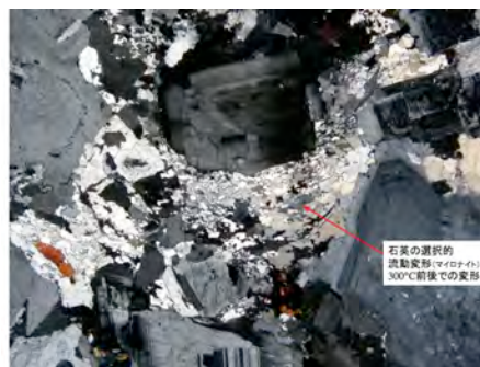
滝谷花崗岩が高温時に地殻変動を受けたことを示す顕微鏡写真
