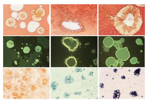
図25 試験管内膜構造物作製実験:14日~21日で定型的膜嚢胞状構造物を形成。上段:未染色,中段;自家蛍光,下段;脂肪染色。
