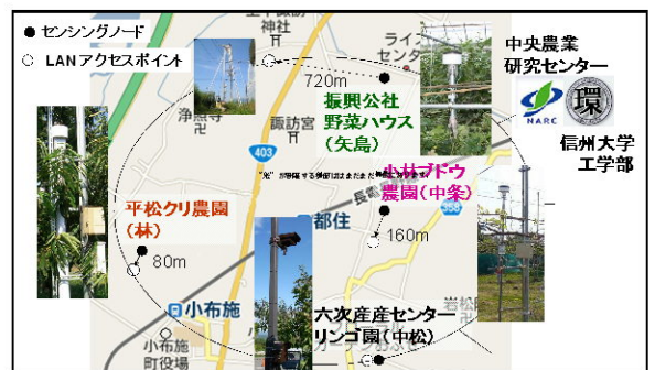
農業環境情報センシングネットワーク・アグリサーバー；農生産情報をネットワーク経由でモニタリングし公開(農ライブ)している
