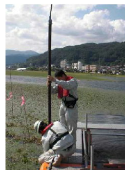
閉鎖性水域における底泥のサンプリングと湖底地盤の強度および密度検層
