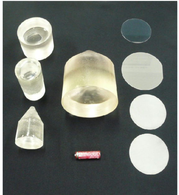
垂直ブリッジマン法により育成したサファイア単結晶。大学では直径2インチ、共同研究企業では直径4インチまでの単結晶を実現
