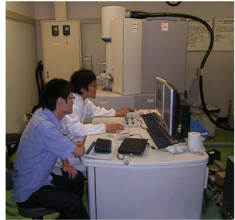
ナノ構造を観察するためには走査型透過電子顕微鏡(STEM)等の最先端電子顕微鏡操作が欠かせない
