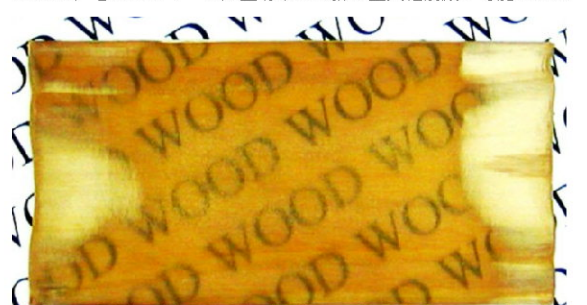
ヒノキから製造された透明性圧縮木材(特許4359681)
