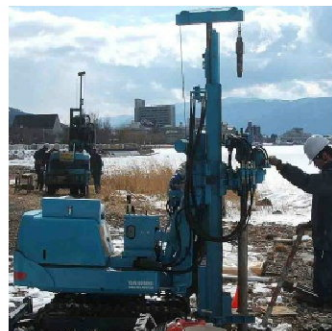
地盤調査のためのボーリングマシンと採取された土質サンプル
