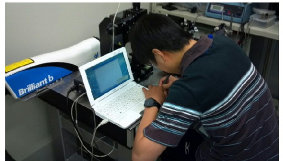
実験風景。左奥に見えるのがレーザ発振器、机のように見えるのが光学除振台でその上に実験環境が構築されている
