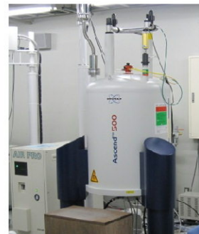
核磁気共鳴装置を用いて、有機化合物の3次元構造を決定する
