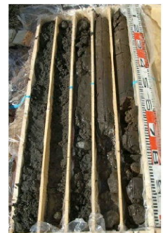
地盤調査のためのボーリングマシンと採取された土質サンプル
