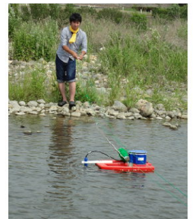
■地下水資源量を調査するため、河川の流量も測定する
