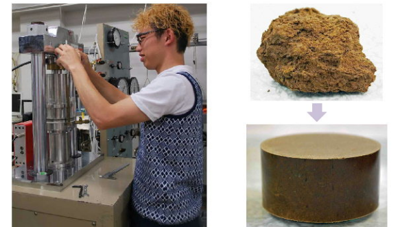
学内より採取した粘土（右上）に数トン以上の荷重をかけて地下数百メートルの地盤を再現した超硬質粘土（右下）
