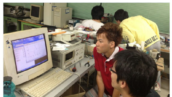
作製した圧電セラミックスの電気的特性の測定。温度や周波数を変化させて、誘電率や共振特性の確認を行う
