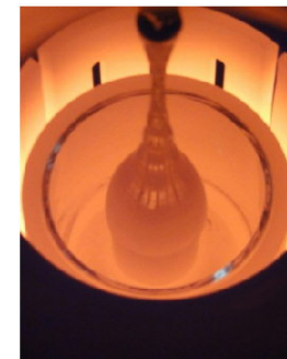
左：引き上げ法によるゲルマニウム単結晶の育成中の炉内の様子。右：育成した単結晶。ゲルマニウム単結晶を扱える大学は少ない
