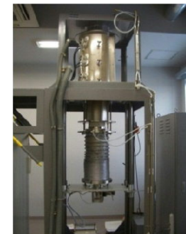
左：垂直ブリッジマン方式の結晶育成装置、右：引き上げ方式の結晶育成装置。この他に4台の結晶育成装置を保有している
