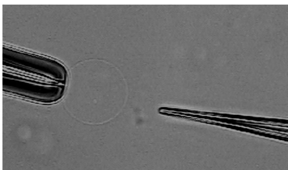
巨大リポソームに対するマイクロマニピュレーション。人工授精などと同様に極細のガラス針を通して物質を注入するなどの操作ができる
