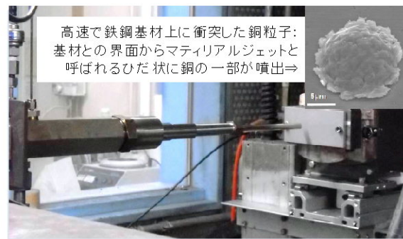
試作したCSガンノズル：ガスを超音速流にするため先細末広円筒ノズルとし、その中に金属粒子を投入して加速・加熱し、衝突・成膜
