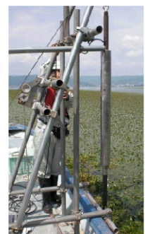
閉鎖性水域における底泥のサンプリングと湖底地盤の強度および密度検層
