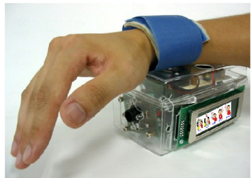
言語障がい者の会話を支援するウェアラブルな会話エイドシステムの試作機(指先の動きでカーソルを移動し、音声を出力する)
