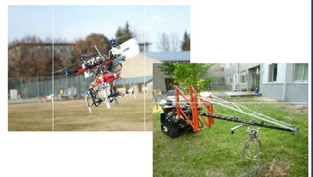
左上：ヘリコプターから飛行機へ変形していく飛行ロボット 右下：腕、カメラ、車両の全てを同時に全身制御する農業ロボット
