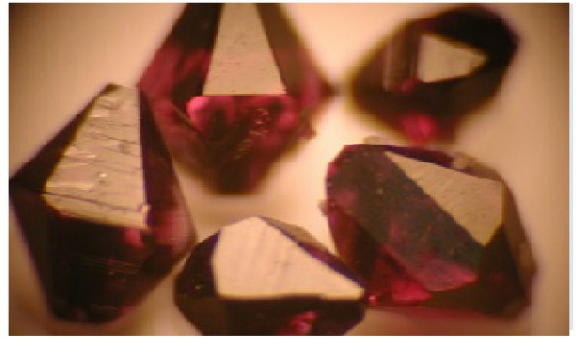
合成したルビー結晶。それぞれの形はその表面張力で説明できる
