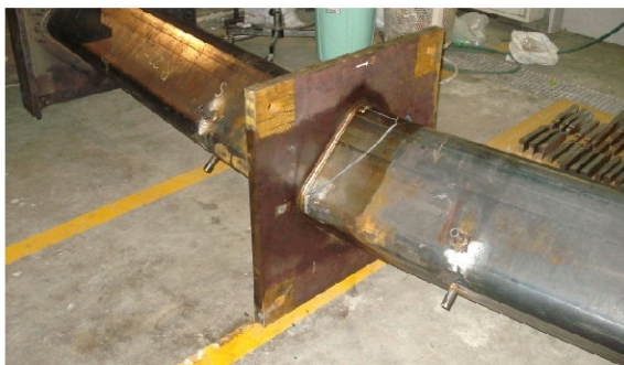
大型アクチュエーターで荷重をかけ破断させた柱部分の試験体。スパンが4mの実大試験体となっている
