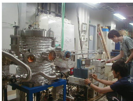
ホットワイヤーCVD法での炭化ケイ素薄膜の作製実験の様子。1500度以上に加熱されたフィラメントで原料ガスを分解する
