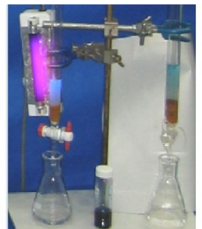
光と粘土鉱物を用いた水質浄化実験
