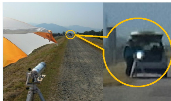
遠距離での可視光通信の実験風景：現在共同研究している企業では、40km 届いたという世界記録をもつ。衛星通信にも挑戦中
