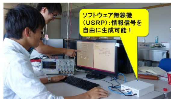
自分で考えた新しいコグニティブ無線信号を、ソフトウェア無線機を利用して電気信号に変換。伝搬特性などの各種評価が行える
