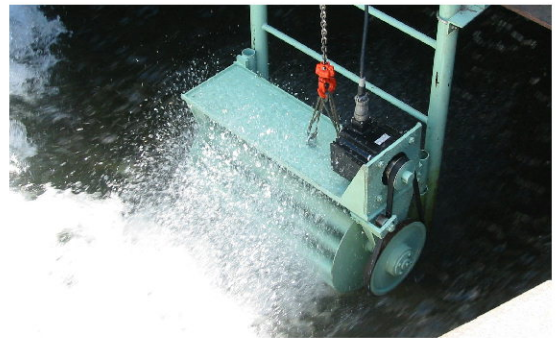
浅速流で発電する下掛けタイプの衝動水車。水車は橋からぶらさげた2本の支柱で支えている。得られた電気は水路脇の民家で利用
