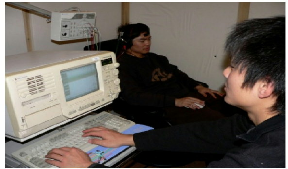
聴覚刺激により導出された脳波から、ある特定の刺激に対応したP300ERP成分を抽出してBCIシステムを構築する研究を行っている
