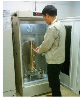
土壌と微生物を利用した維持管理の容易な脱窒素処理装置
