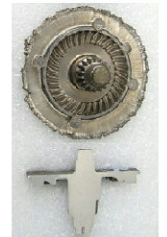
図2 MWCNT導入マグネシウム合金を鍛造し製造した釣り具用フェイスギア (硬度と強度を改善)
