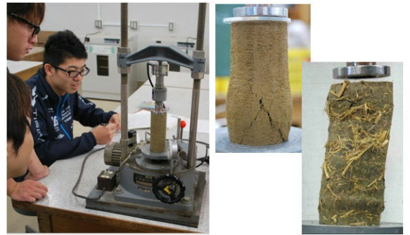
3年生の授業での実験（左）、土だけでは亀裂が入って破壊（右上）、稲わらを混ぜると強度が格段に増加（右下）
