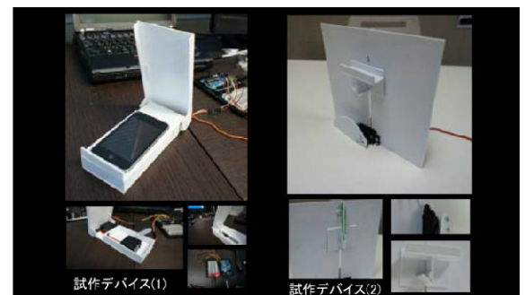
Peripheral Cognition Technologyに基づく姿勢を変化させて着信通知する人間を邪魔しない情報端末
