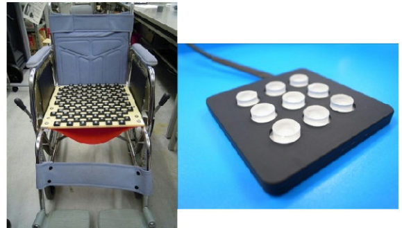
中山研究室で開発した柔軟であり荷重の大きさや方向を検知できる新しいセンサ（右側）とセンサを多数設置した車いす（左側）
