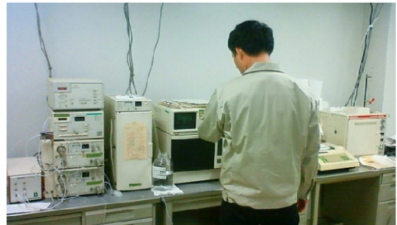
汚染状況や処理装置の性能を確認するため、水質を様々な分析装置で測定する(写真はイオンクロマトグラフ)
