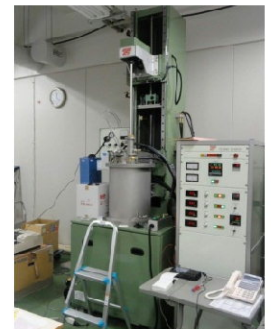
左：垂直ブリッジマン方式の結晶育成装置、右：引き上げ方式の結晶育成装置。この他に4台の結晶育成装置を保有している
