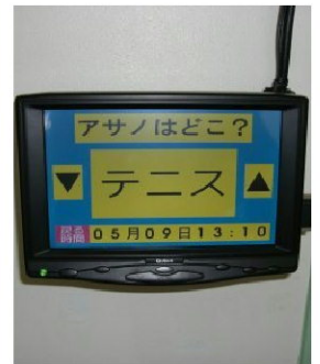
戻る時間が設定でき、インターネット経由でも確認できる
