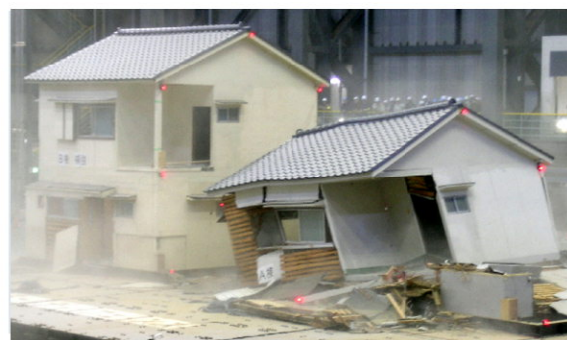
2階建て木造住宅の振動台実験。補強をしてある建物(左)と補強をしていない建物(右)の被害の差は一目瞭然
