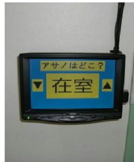
タッチパネルを利用した「在室表示機器」
