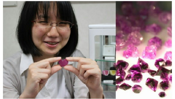
環境調和フラックス法により作製したルビー結晶。ハートの形のルビーコーティング(左)と自形の発達した六角両錐ルビー結晶(右)
