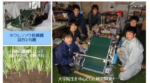
ハウレンソウのような軟弱な野菜を対象とした収穫自動機械の開発。実現できれば、「農業機械の革命」とさえ言われている
