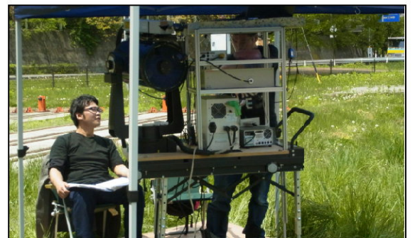
生活・自然環境情報センシングシステム・LIFSライダー；空中スギ花粉、粉塵、諏訪湖水質、植物生育の遠隔センシングに使用中
