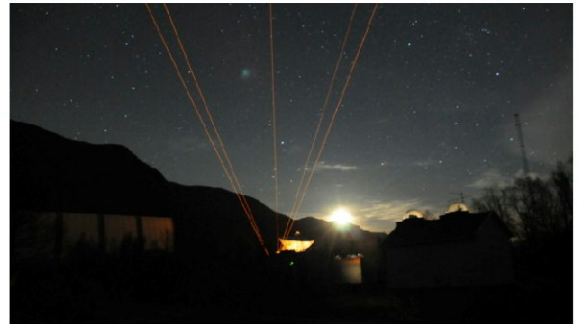
夜空に向けて射出される黄色のレーザー。オーロラ活動時の大気温度の空間変動を調べるため、5方向に射出
