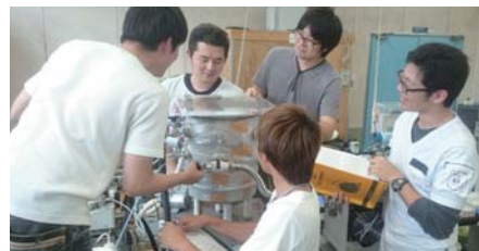
電気をほとんど使わず廃熱から氷スラリーを生成する吸収式冷凍機の実験装置
