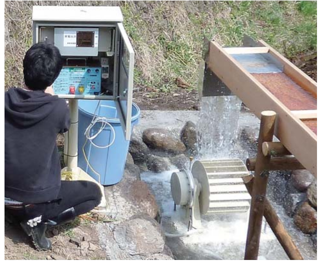
屋外でのエコ水車の実証試験
