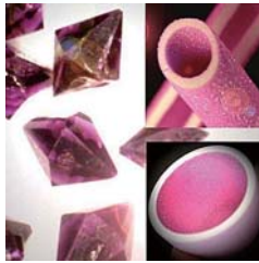
エコプロセスで作製したルビー結晶 環境負荷のきわめて小さい方法で、とても美しいルビー結晶を育成することに世界で初めて成功しました。
