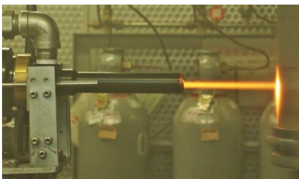
図3 高速フレーム（HVOF）溶射法による硬質なWC/CoCr系皮膜の作製（榎研究室にて）
