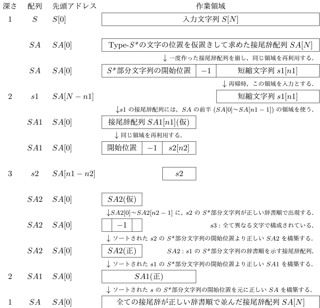
図7 作業領域の再利用の例 (3段目まで再帰した場合). 接尾辞配列 SA の領域を使いまわすことで, その後の処理に新たな領域を必要としない.
