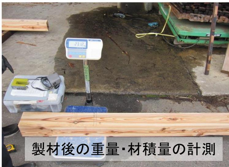
製材後の重量・材積量の計測
