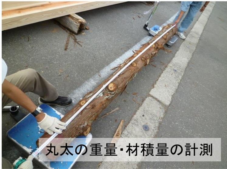
丸太の重量・材積量の計測
