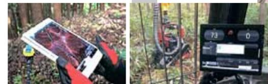
ドローンで解析した間伐木の位置情報は伐採作業員が持つタブレット端末やGNSSを装備した自動検尺機能付きIoTハーベスタに送られ、間伐木へのナビゲーション、伐採と丸太の採材情報がインターネットを通じて情報共有します。
