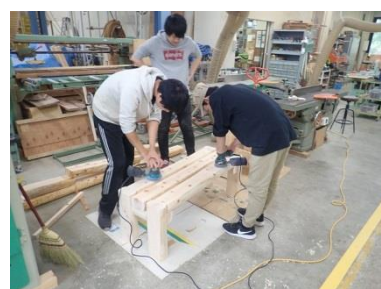
図17 ランダムサンダーを用いた仕上げ作業
