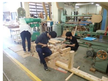
図16 ノミを用いた接合部分の加工作業
