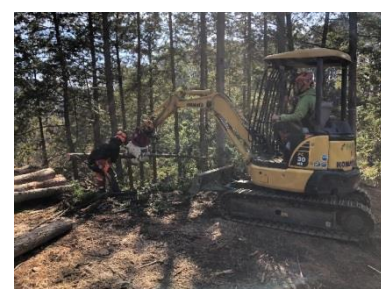
図 33 グラップルを用いた丸太のはい積み
