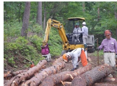
図 22 チェーンソーによる造材作業とグラップルによる積み込み作業
