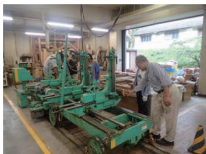
図-9 帯鋸盤による製材作業
