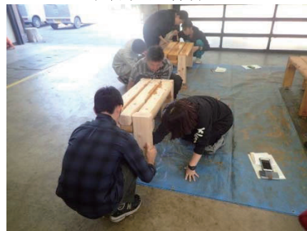
図-12 木材保護塗料の塗装作業
