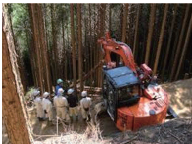
図-38 スイングヤーダによる集材作業
