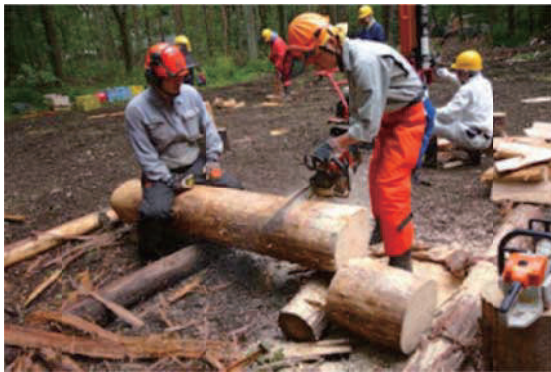
図-31 チェンソーを使って丸太を玉切り
