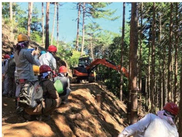
図-36 バーベスタによる伐倒・造材作業
